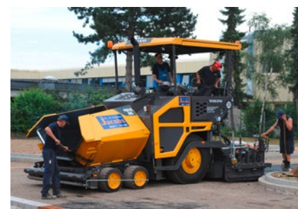
Der 360-Grad-Rundumblick und der ausstellbare Fahrersitz sorgen für eine perfekte Sicht.
